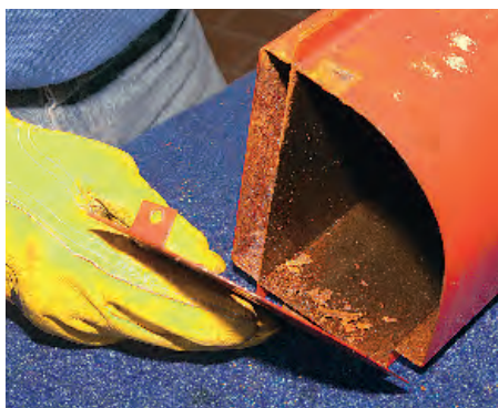
Schon beim Abnehmen der Seitendeckel erwartet un die braune Pracht
