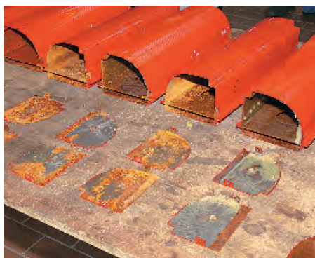
Die Seitendeckel aus (ehemals) blankem Blech dienen als Kriterium für das Haftvermögen
