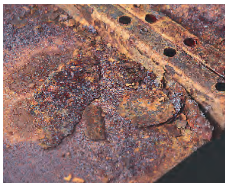
... der Produkte. Hier (Elaskon) ist mit baldigen Durchrostungen zu rechnen
