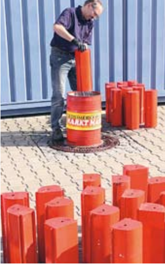
Auch zum dritten Salzen gingen die Schweller auf Tauchstation
