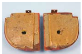
Auch auf den blanken Deckeln haftet das TimeMax-Fett gut
