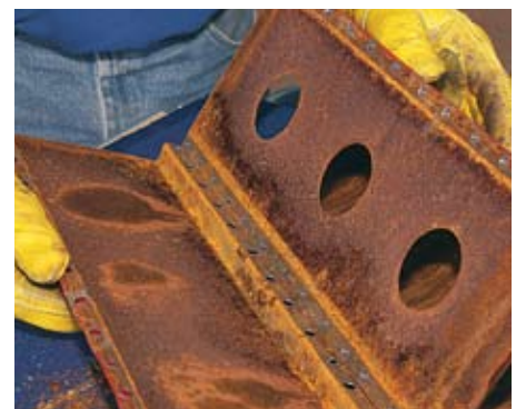
Dabei lässt es sich nicht vermeiden, dass Rost durch die Löcher in die Hauptkammer rieselt
